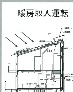
天気のよい日には、壁の下から取り入れた冷たい空気は、壁から屋根上部へと徐々に温度を上げながら上昇していきます。標準温度が所定の温度に達すると、温まった空気を床下へと吸入します。
