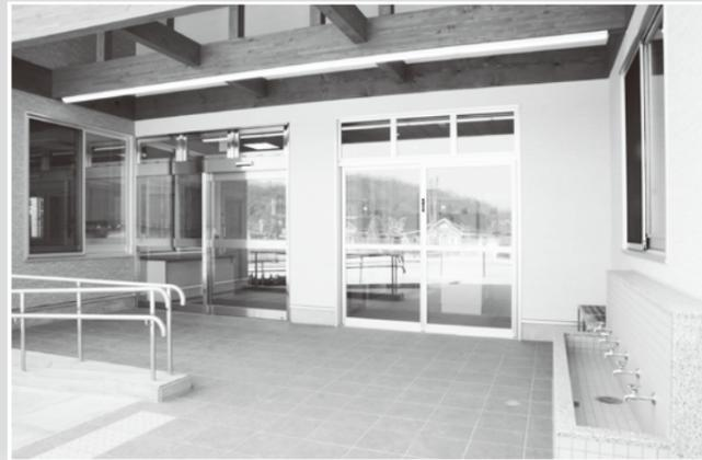
福山市内に建つ公立の保育所で、既存の園舎の老朽化による園舎建て替え。住宅地の中にあるため、外観は周囲になじむような仕上げとした。各居室から園庭に直接アクセスでき、子どもたちの保育環境、安全に配慮するとともに、床・壁を可能な範囲で木質化し、木のぬくもりを感じられるような計画とした。廊下に通風用のトップライトを設けており、居室の窓を開放することにより、中間期の省エネに配慮している。また、構造材の一部に県産材を使用している。
