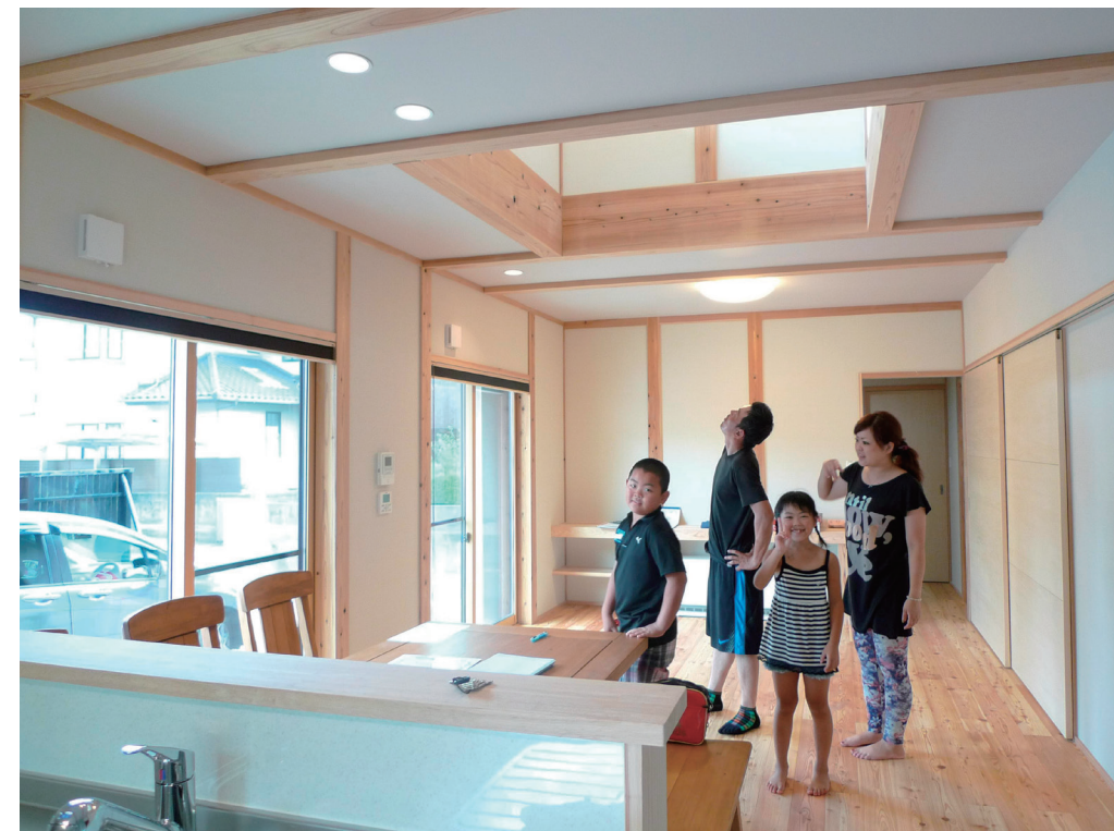
LDK 夏・冬はしっかり締めて、家全体が同じ温湿度になるように。 春・秋はおもいっきり開いて風・光をしっかり取り込む様に吹き抜けを設けています。
