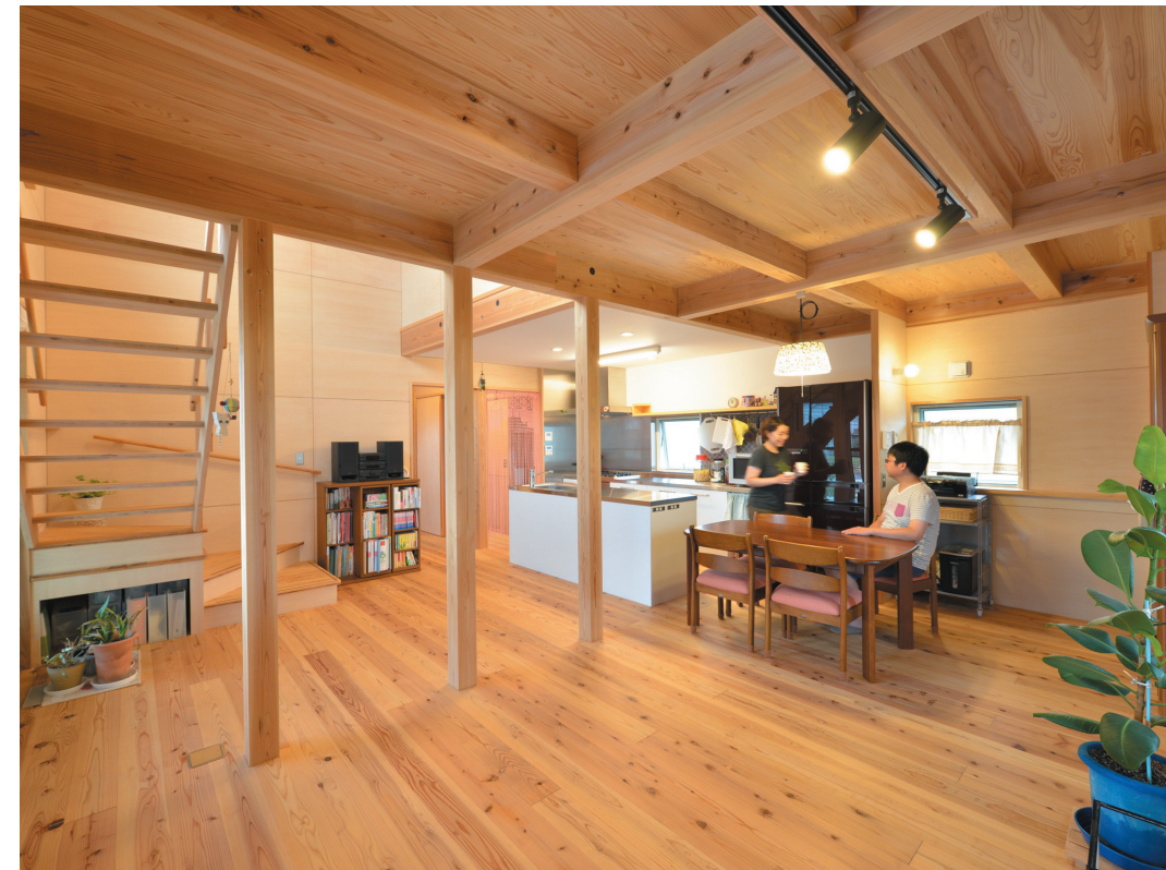
2階へ続く吹き抜け部の階段は窓から多くの光を取り込めるように設計。1階の掃き出し窓にはルーバー雨戸を設置し、夏は日射を遮蔽しながら室内に風を通す。冬は2階の窓からたくさんの太陽光を取り込み温かな温熱環境を実現する。
