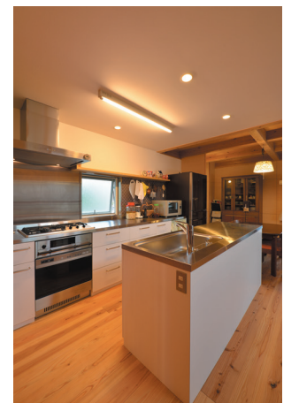
回遊性を意識したアイランド型の作業台を設けることで、コンロ・作業台・冷蔵庫が三角形の動線を描くよう設計されたキッチン。
